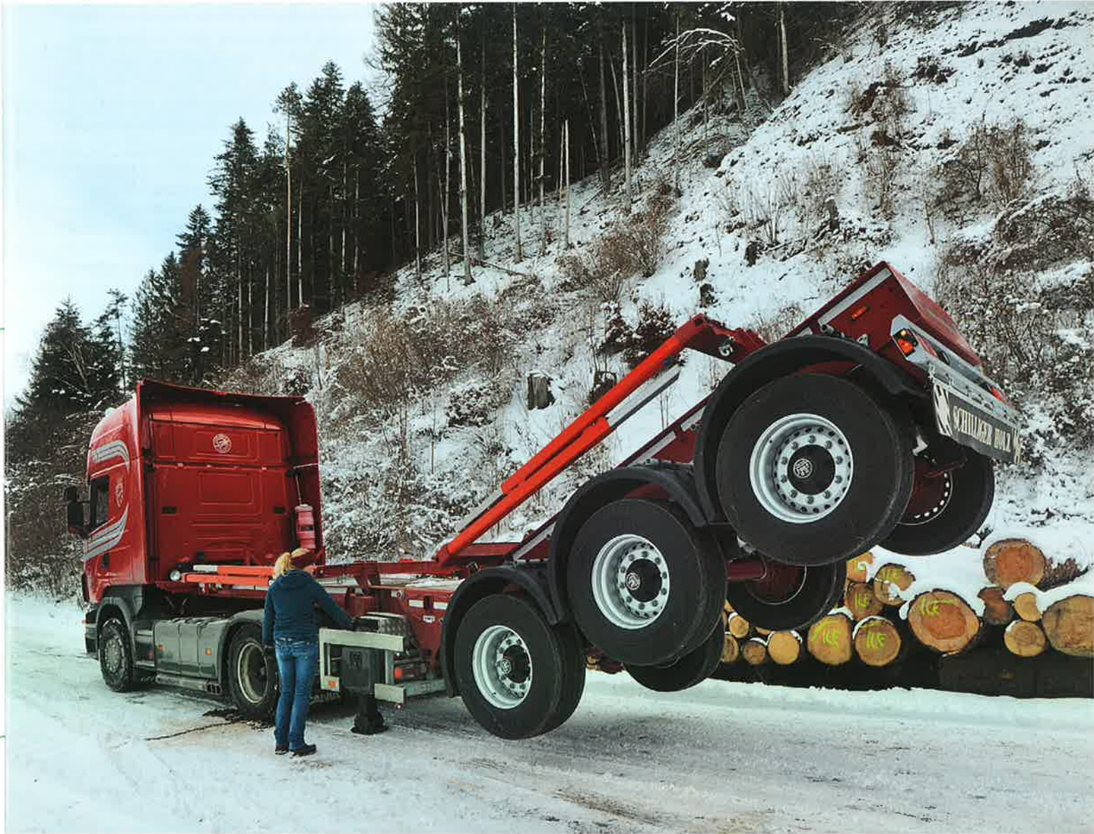
Die Stützbeine sorgen für Stabilität beim Klappvorgang
