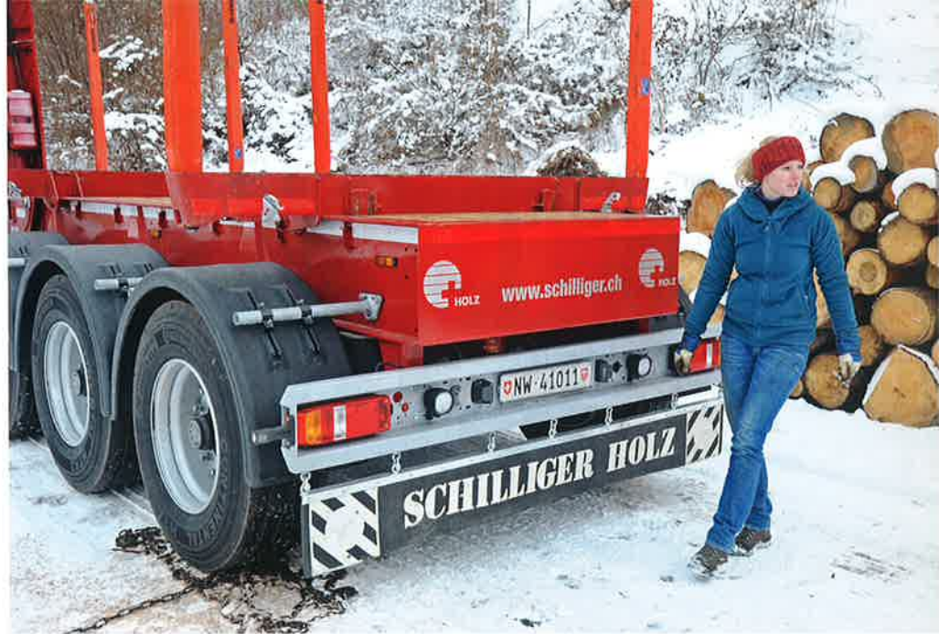
Sarah geht um den «entfalteten» Aufleger und verschiebt ihn dann dank beweglichem Königszapfen nach hinten.
