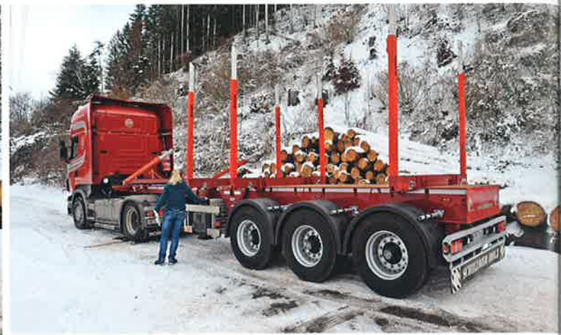
In wenigen Minuten ladebereit: Sarah Schmid «entfaltet» den von Mobas gebauten Faltaufleger vom zentralen Bedienpult aus.
