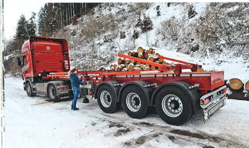
In wenigen Minuten ladebereit: Sarah Schmid «entfaltet» den von Mobas gebauten Faltaufleger vom zentralen Bedienpult aus.
