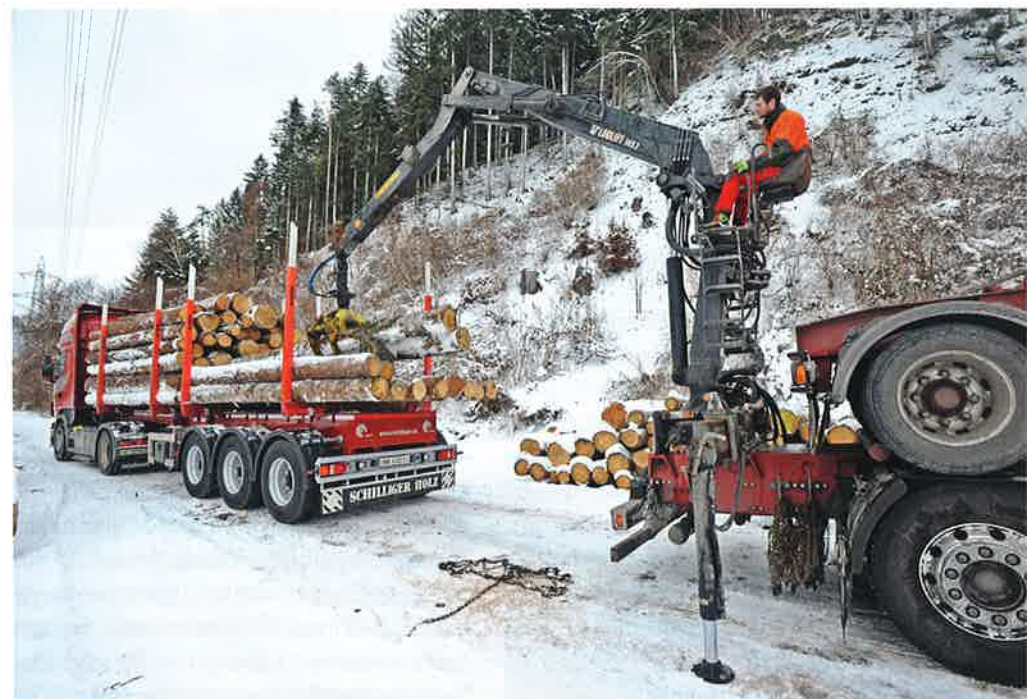
Sarah geht um den «entfalteten» Aufleger und verschiebt ihn dann dank beweglichem Königszapfen nach hinten.
