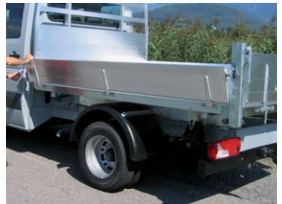
Zentralverschluss , schnelleres Öffnen hinten, keine Beschädigung der Leuchten
